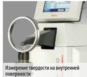
Измерение твердости на внутренней поверхности
