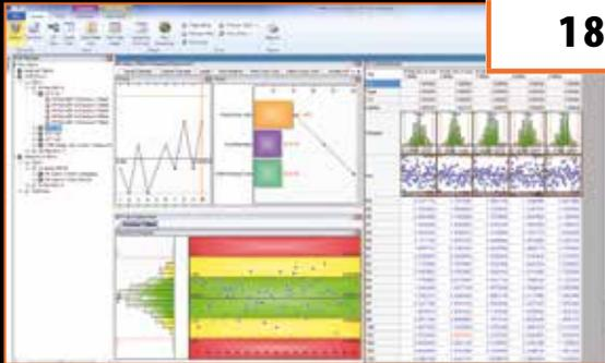
> MeasurLink Real-Time Professional Edition (модуль для работы в режиме реального времени) позволяет клиентам подключаться и получать данные с координатно-измерительных машин, видеоизмерительных машин и формоизмерительного оборудования Mitutoyo благодаря встроенной системе интеграции (DDE).
