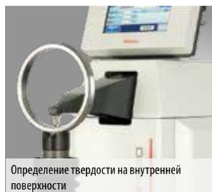
Определение твердости на внутренней поверхности
